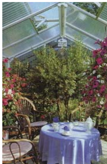
Skleníkový typ zimní zahrady vyžaduje dobře izolovanou konstrukci a dokonalou klimatizaci. Vhodná je střeška z komůrkových polykarbonátových desek.
